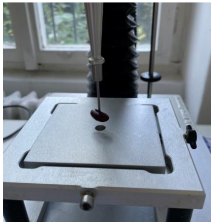
7. ábra: TA.XTplusC típusú készülékkel történő konzervbab állománymérése (Forrás: saját kép)
