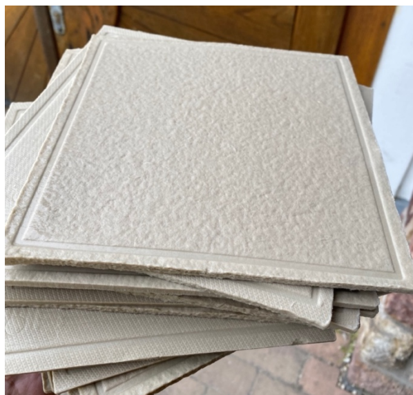
35. ábra: Elhasználódott szűrőlapok (forrás: saját fotó)
