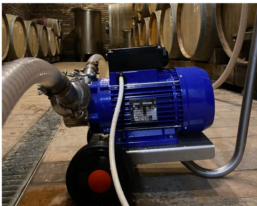
32. ábra: Fejtéshez használt szivattyú (forrás: saját fotó)
