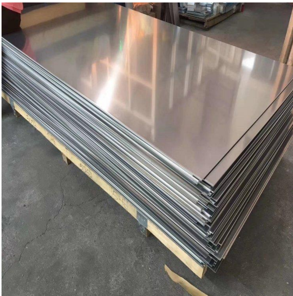
15. ábra 1000x2000x1,5 alumínium táblalemez nagykiszerezelésben a forgalmazónál.
