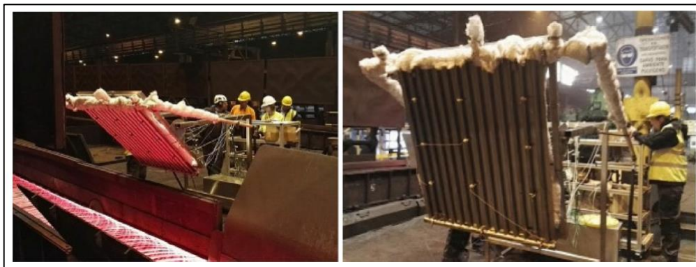
Ábra 29. Hőcső alkalmazása gyári környezetben, sugárzásos hőhasznosításra
