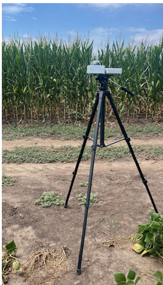
8. ábra. A levélfelület index mérése SunScan Canopy Analysis System (SS1) eszközzel.
