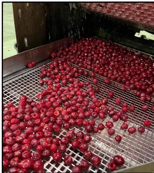
45. ábra: Meggy magozása magozógéppel (Forrás: saját fénykép, 2022)
