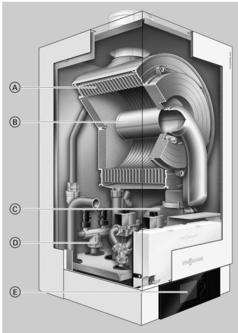
16. ábra: A tervezett gázkazán elvi felépítése
