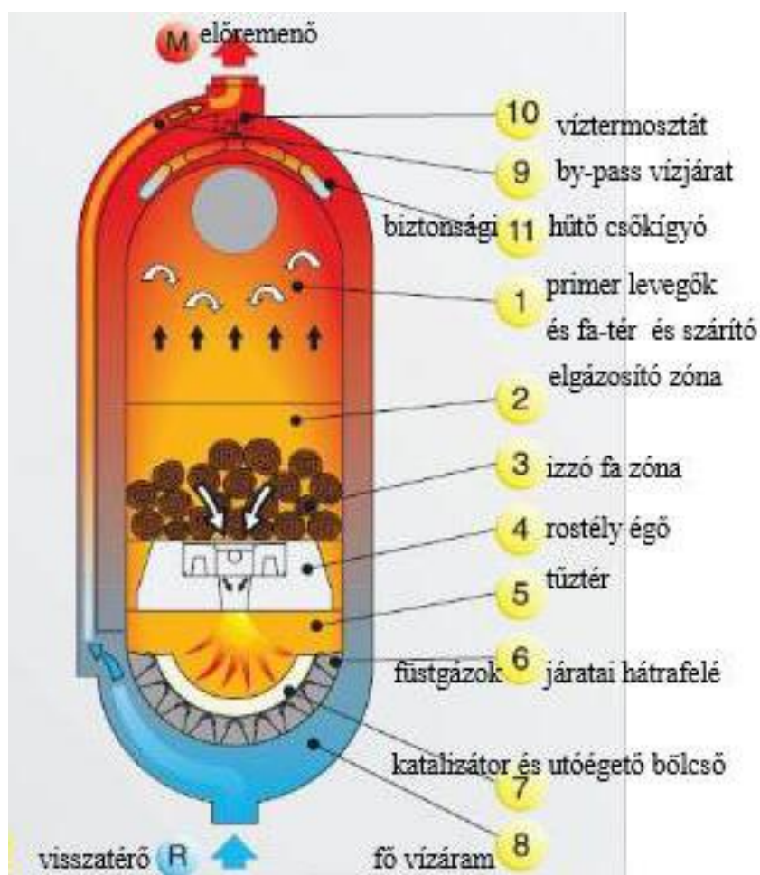
6. ábra: Elvi ábra Unical Gasogen típusú faelgázosító kazánról
