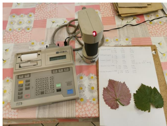
4. ábra: Minolta CR-200 színanalizátor próbamérés közben (Forrás: saját felvétel), Pölöske, 2023.
