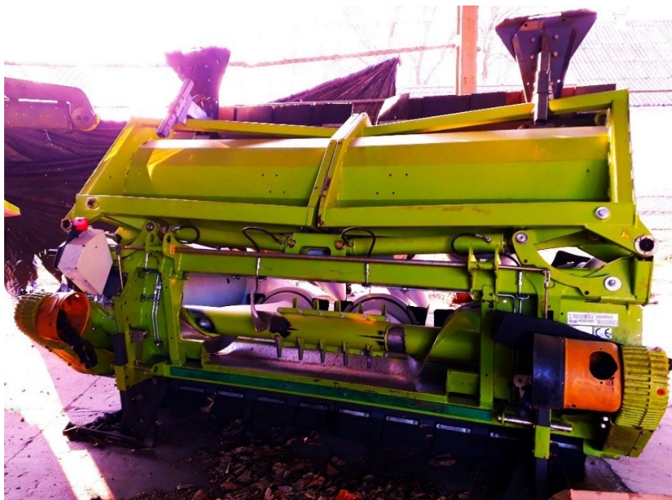
36. ábra: 660-as LEXION összecukható, szárzúzó kukorica csőtörő adapterje
