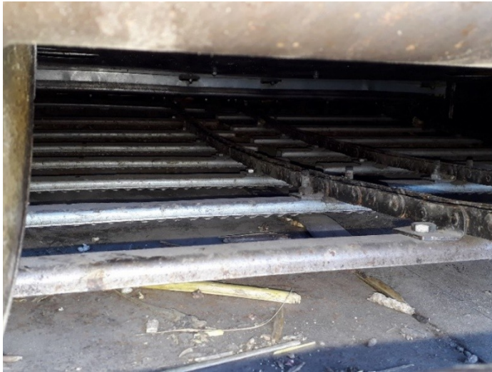
21. ábra: Laza szállítólánc, kopott kaparólécek
