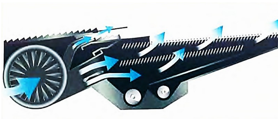
27. ábra: CLAAS LEXION 540 típus 5,1\text{m}^2 -es mag tisztító rendszerének levegő áramlási modellje
