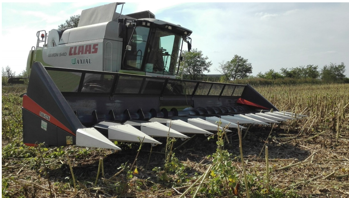
17. ábra: NAS 1276 merevvázás rezgőtálcás napraforgó adapter munka helyzetben
