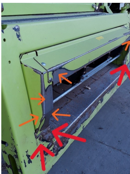
23. ábra: A másik 540-es típusú gép(B) ferdefelhordóján a záró lemezek és a felfogató csavarok kopottak.
