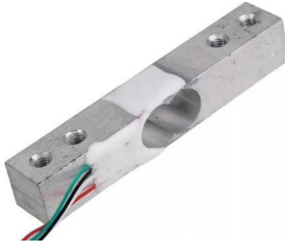
14. ábra: A nyúlásmérő bélyeggel ellátott erőmérő cella (http17)
