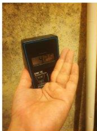
2. ábra: Magas falfelületi nedvesség érték (a szerző felvétele)
