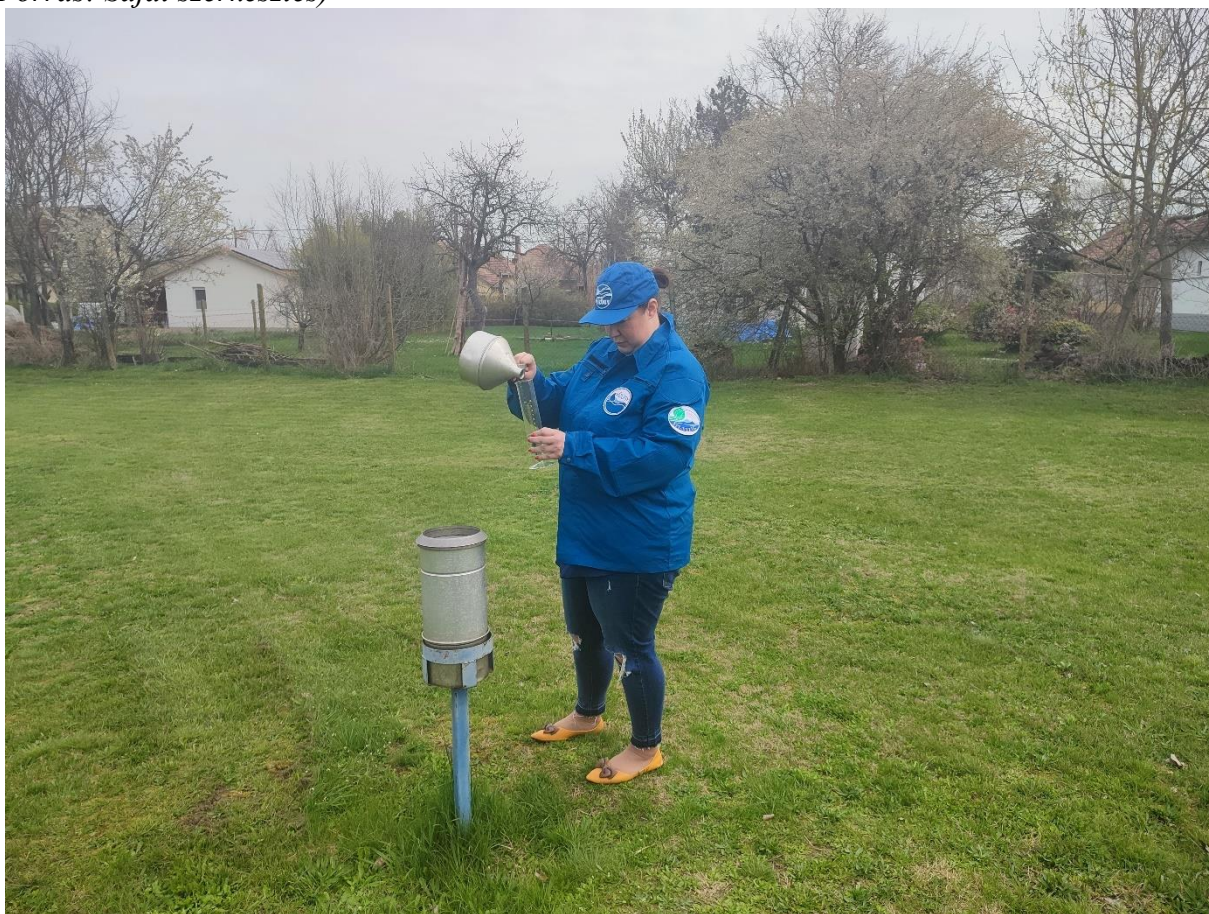
8. ábra: Csapadékmérés a mártélyi gátórháznál (Hellmann-féle csapadékmérővel) (Forrás: Saját szerkesztés)
