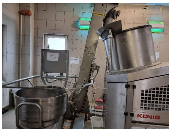
7. ábra: Dagasztócsésze emelő szerkezet (forrás: saját kép)
