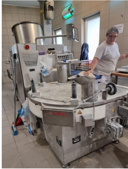
8. ábra: Kenyérosztó berendezés (saját kép)
