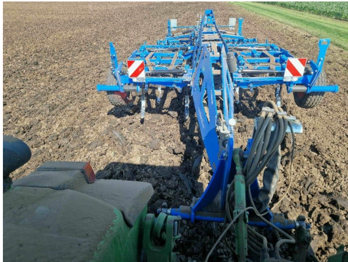
14. ábra Szántóföldi kultivátor kapa kialakítása és a művelés utáni talaj állapot a forgón. 2023.június 18. Forrás: Kovács Tibor felvétele
