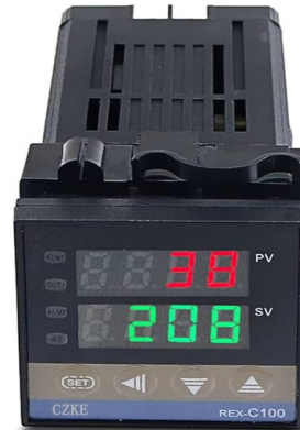
8. Ábra: PID hőmérséklet szabályozó ( Forrás: Internet3 )
