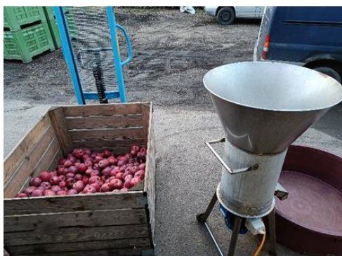
9. ábra: Késes daráló berendezés (Forrás: Saját kép)
