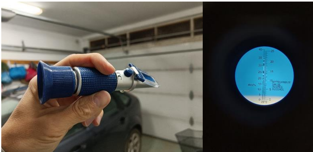
18. ábra: ATC típusú kézi refraktométer (Forrás: Saját kép)
