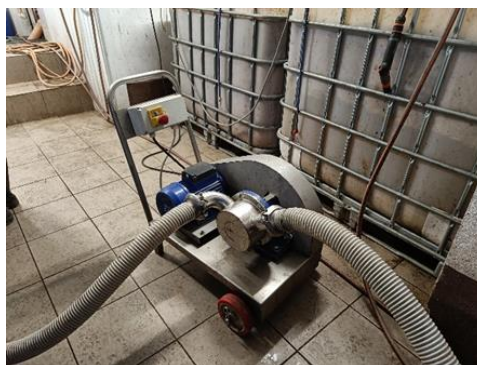
10. ábra: Cefre továbbító szivattyú (Forrás: Saját kép)
