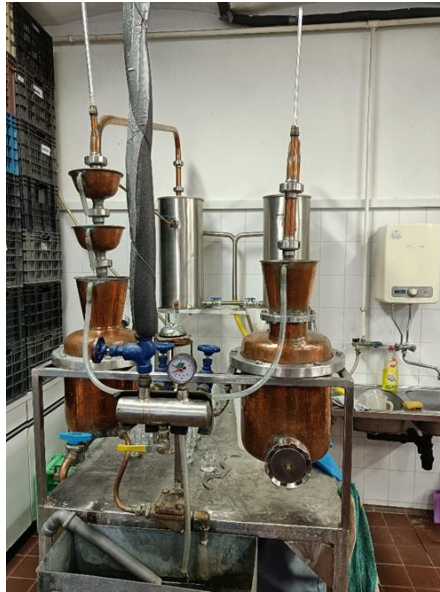
1. ábra: Kisüsti berendezés (Forrás: Saját fénykép)
