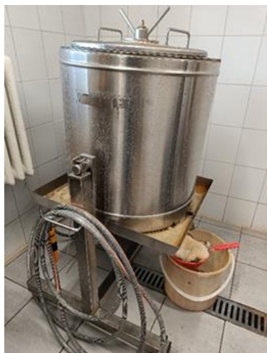
7. ábra: Víznyomásos prés gép (Forrás: Saját kép)
