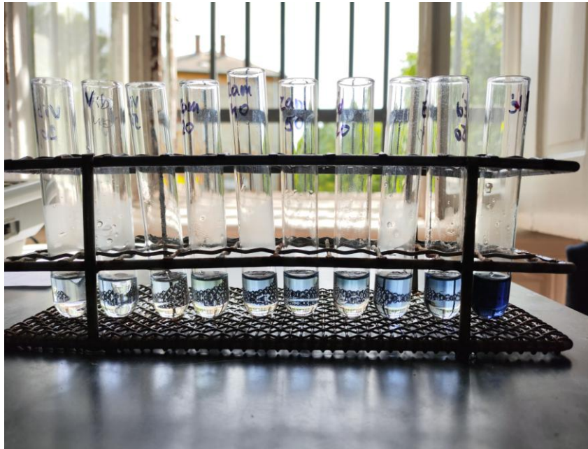
11. ábra A kék színárnyalatok erősségéből már következtethetünk a minták összpolicfenol tartalmára. Minél erősebb a kék árnyalat annál magasabb lesz a minta TPC értéke. (forrás: saját kép)
