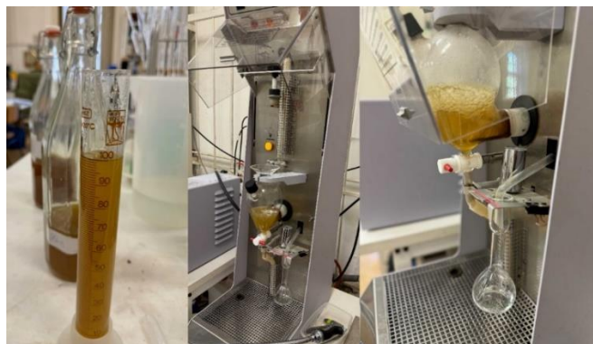
12. ábra: Gibertini elektromos desztilláló berendezés használata (Forrás: saját fénykép)
