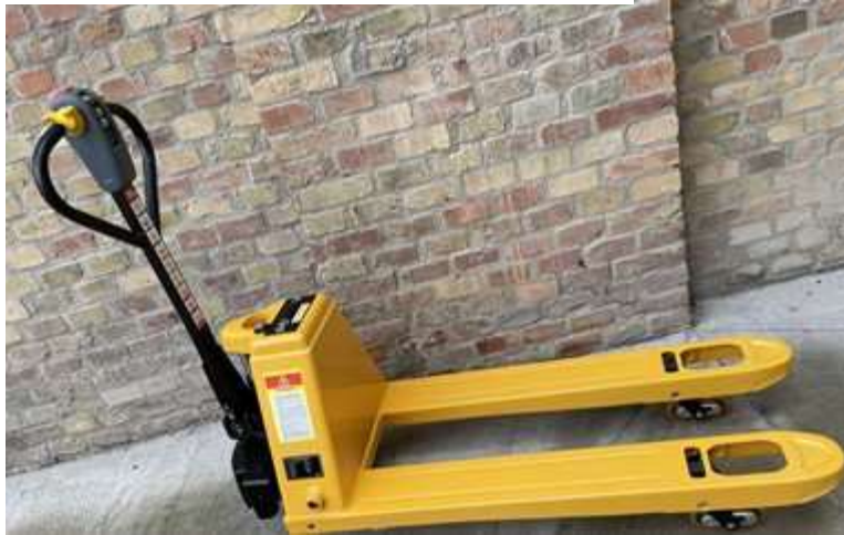
19. ábra elektromos béka (Forrás: saját kép)
