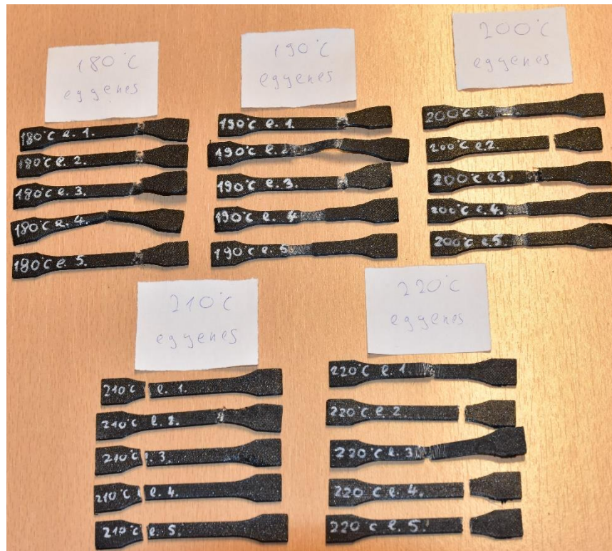
37. ábra: Párhuzamos nyomtatás összes hőmérsékleten a szakítás után, előnézet [Forrás: A szerző saját készítése, fényképezve: 2023.10.25.]
