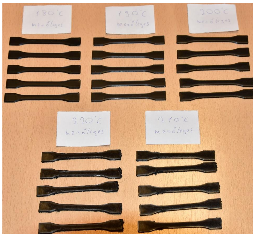
32. ábra: A próbatesttel merőleges nyomtatás összes hőmérsékleten hátulnézet [Forrás: A szerző saját készítése: 2023.10.25.]
