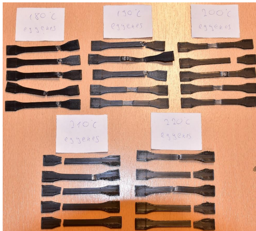
38. ábra: Párhuzamos nyomtatás összes hőmérsékleten a szakítás után, hátulnézet [Forrás: A szerző saját készítése, fényképezve: 2023.10.25.]
