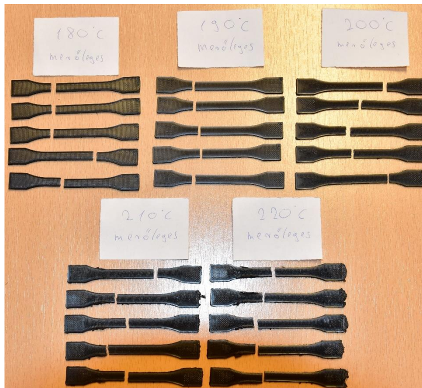
40. ábra: Merőleges nyomtatás összes hőmérsékleten a szakítás után, hátulnézet [Forrás: A szerző saját készítése, fényképezve: 2023.10.25.]
