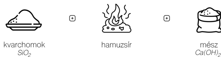
2. ábra: Üvegfajták előállítási módja Készítette: Baranyai Zsombor, 2023
