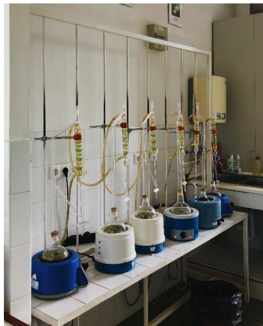
13. ábra. Clevenger típusú laboratóriumi vízdesztillációs berendezés (fotó: Várallyay, 2022)
