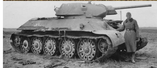
53. ábra: Állharckocsi Ligetfalu határában (Felül) (Forrás: Saját fotó) és a nagy valószínűséggel mintául szolgáló T-34/76 mod. 1941 szovjet közepes harckocsi (Alul) (Forrás: URL-35)
