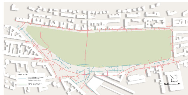
Elválasztott és egyesített csatornarendszer
