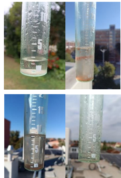
16. melléklet: Hőmérséklet és csapadék adatok, csapadék mérés (Forrás: Saját szerkesztés és fényképek, 2023)
