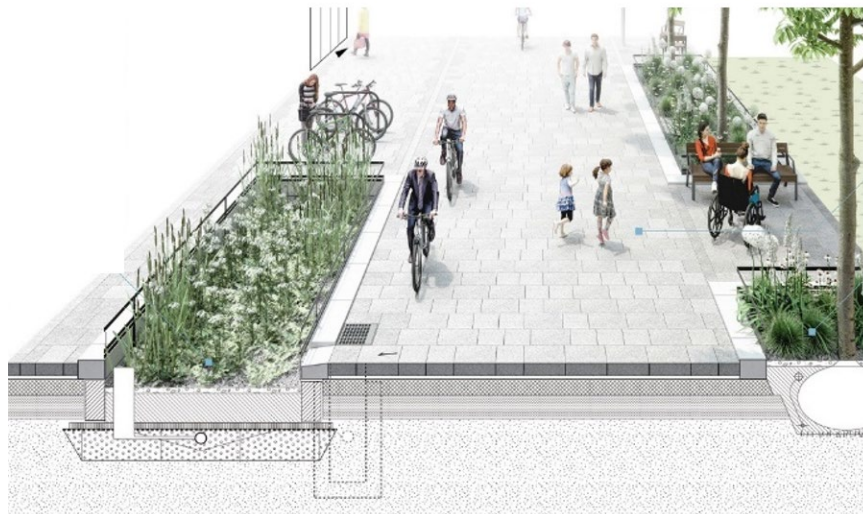
30. ábra Burkolt felületben speciális ültetőközeggel kialakított esőkert Forrás: edge
