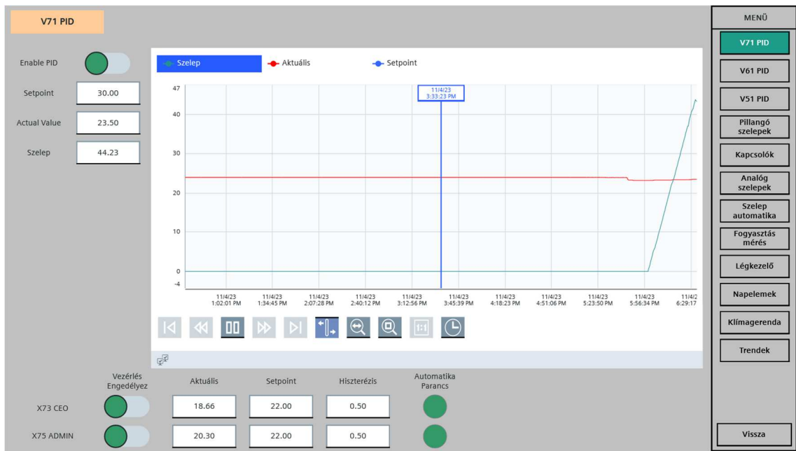
33. ábra A CEO és az adminisztrációs iroda padlófűtésének elindítása
