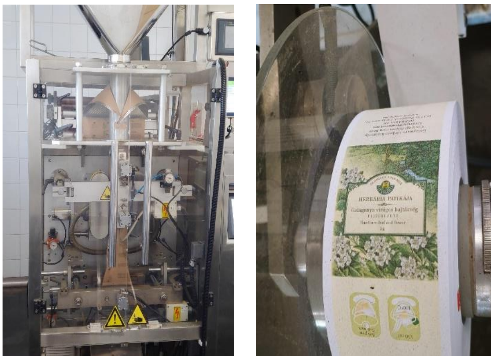
14. ábra: Tasakoló automata és aromazáró tasak filterezett termékhez (Forrás: Saját felvétel 2024. április 06.)
