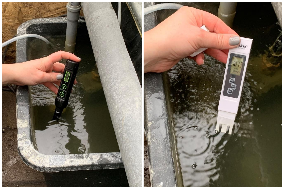
21. ábra: A víz kémhatásának és elektromos vezetőképességének mérése (Forrás: Saját felvétel, 2024.02.14.)
