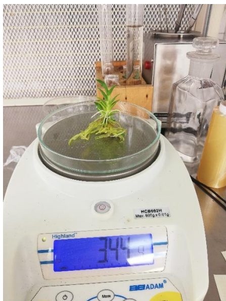
7. ábra Highland HCB602M típusú laboratóriumi mérleg
