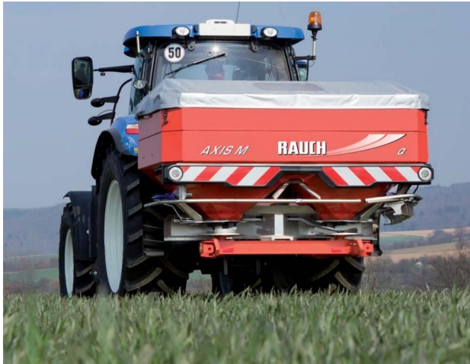
3. ábra. Helyspecifikus tápanyagkijuttatásra alkalmas szilárd műtrágya szórógép. ( http 5)
