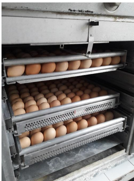
7. ábra RAGUS® típusú asztali keltetőgép (SAJÁT)
