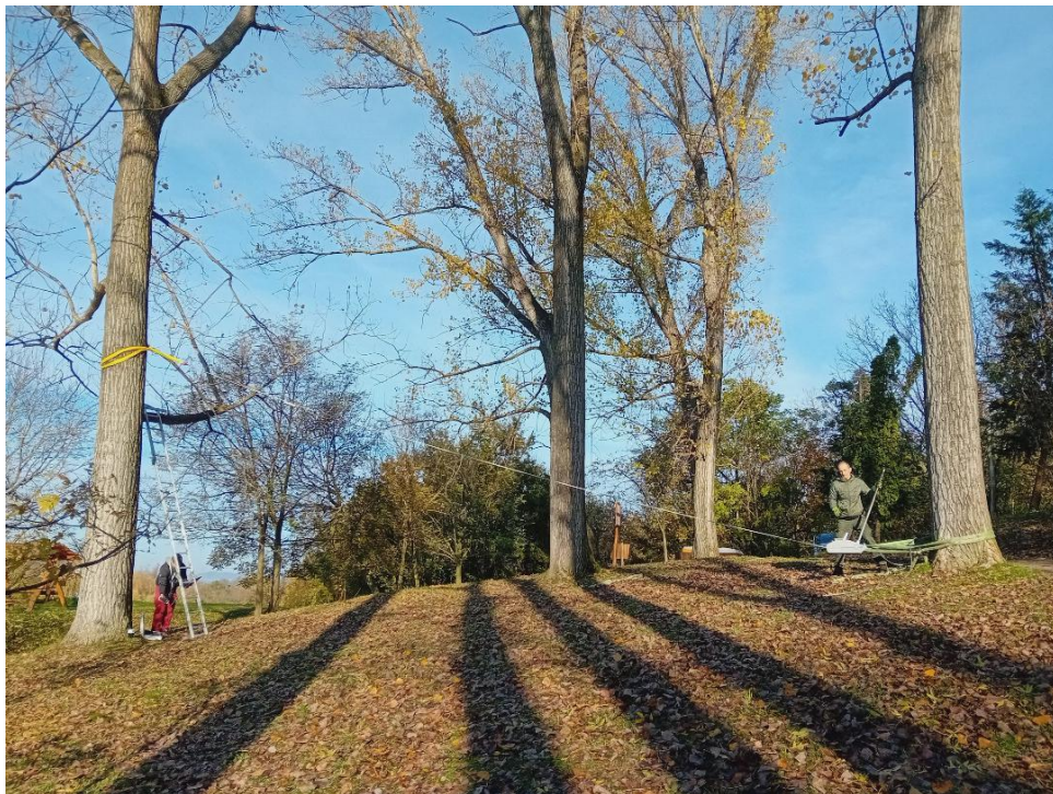
7.ábra: Húzásvizsgálat (fotó: Halwax Mihály, 2023)
