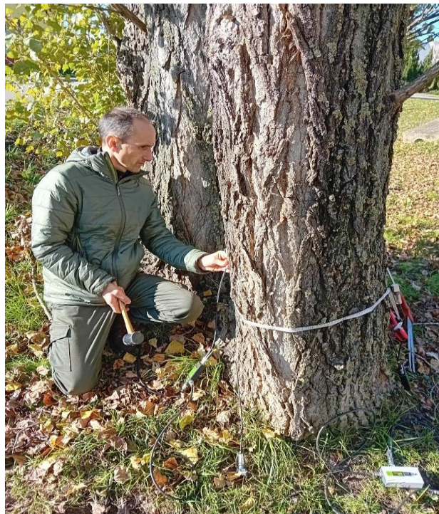
6.ábra: Fakopp vizsgálat (fotó: Halwax Mihály, 2023)
