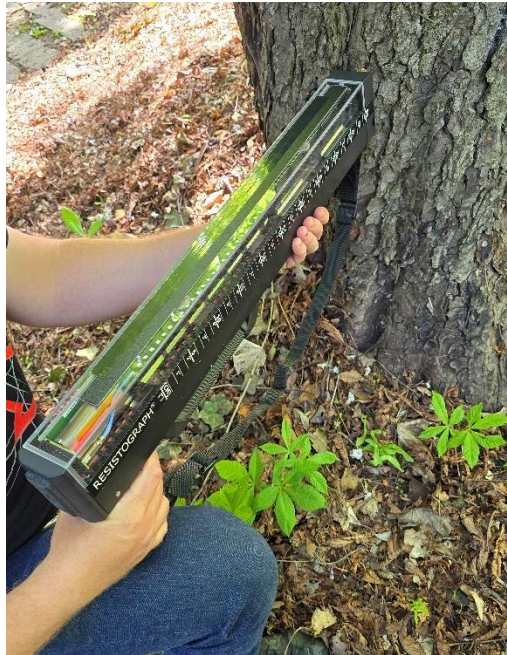
3 ábra: Rezisztográf használat közben (Forrás: Gyuris, 2024)
