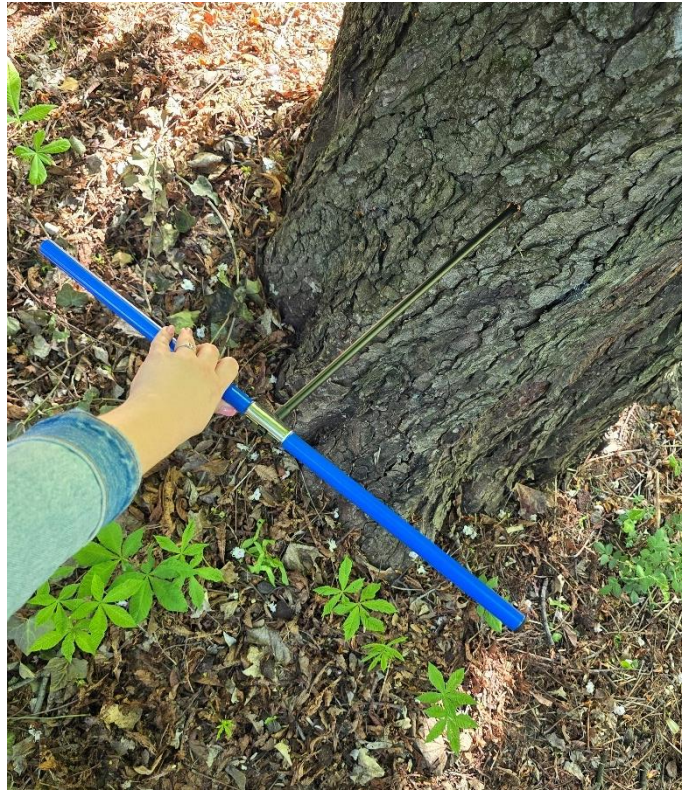
2. ábra: Növedékfúró alkalmazás közben (Forrás: Gyuris, 2024)
