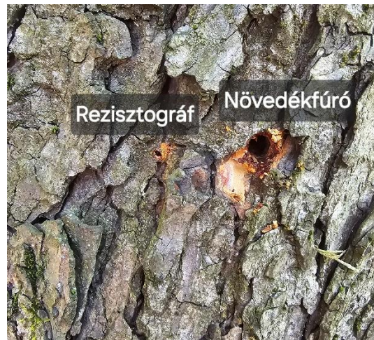
4 ábra: Rezisztográf és növedékfúró nyoma (Gyuris, 2024)
