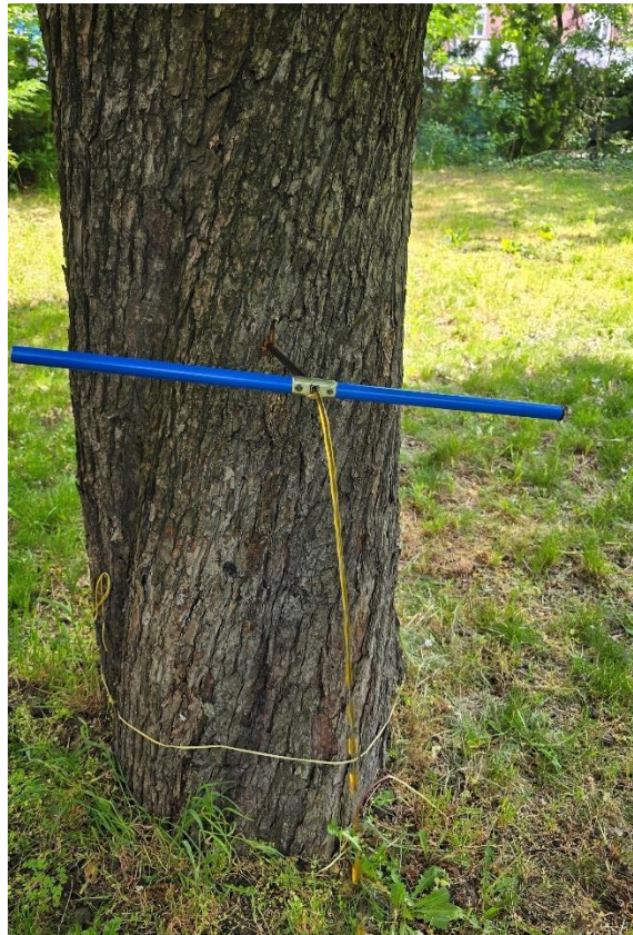
6. ábra: A növedékfúrón keresztül az üregben álló víz kiürült a fából (2024, Gyuris)
