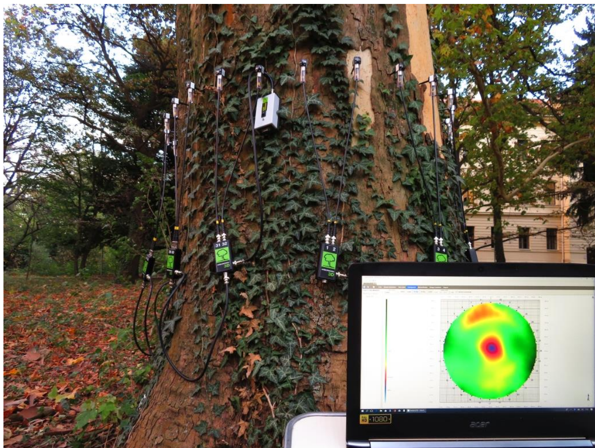
5. ábra: Fakopp 3D műszer és tomogramja Forrás: Internetes forrás 4
