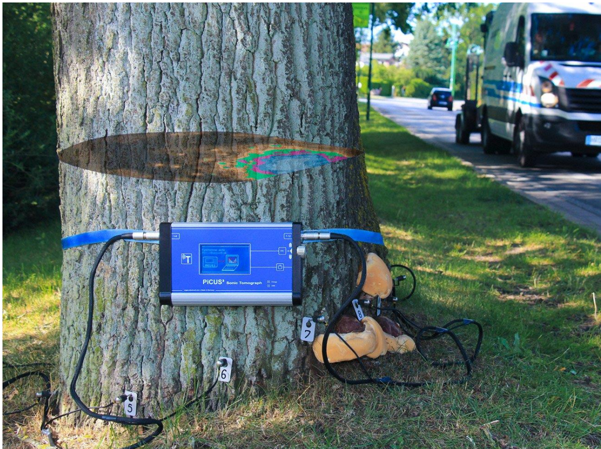
1. ábra: A PiCUS tomográf az érzékelőivel, valamint az általa készített tomogram a fa képeére illesztve Forrás: Internetes forrás 1
