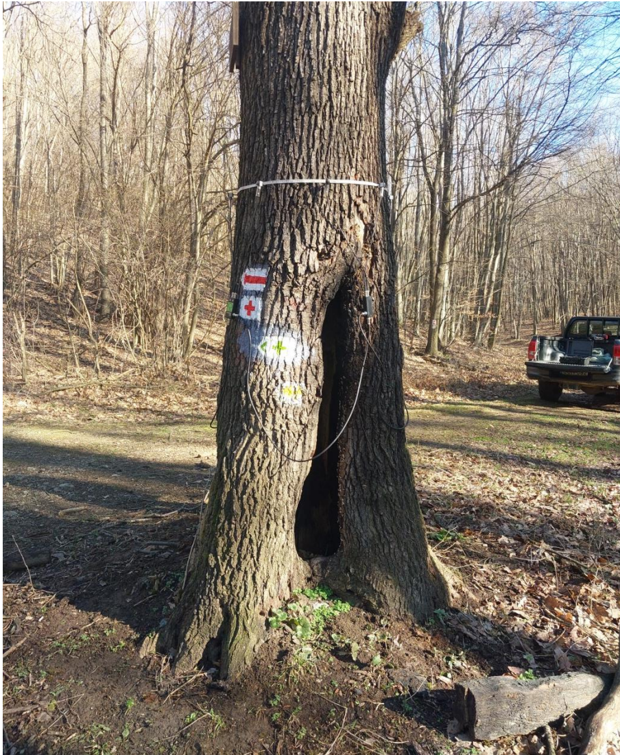
22. ábra: Műszeres keresztmetszeti vizsgálat (saját felvétel, 2024)
