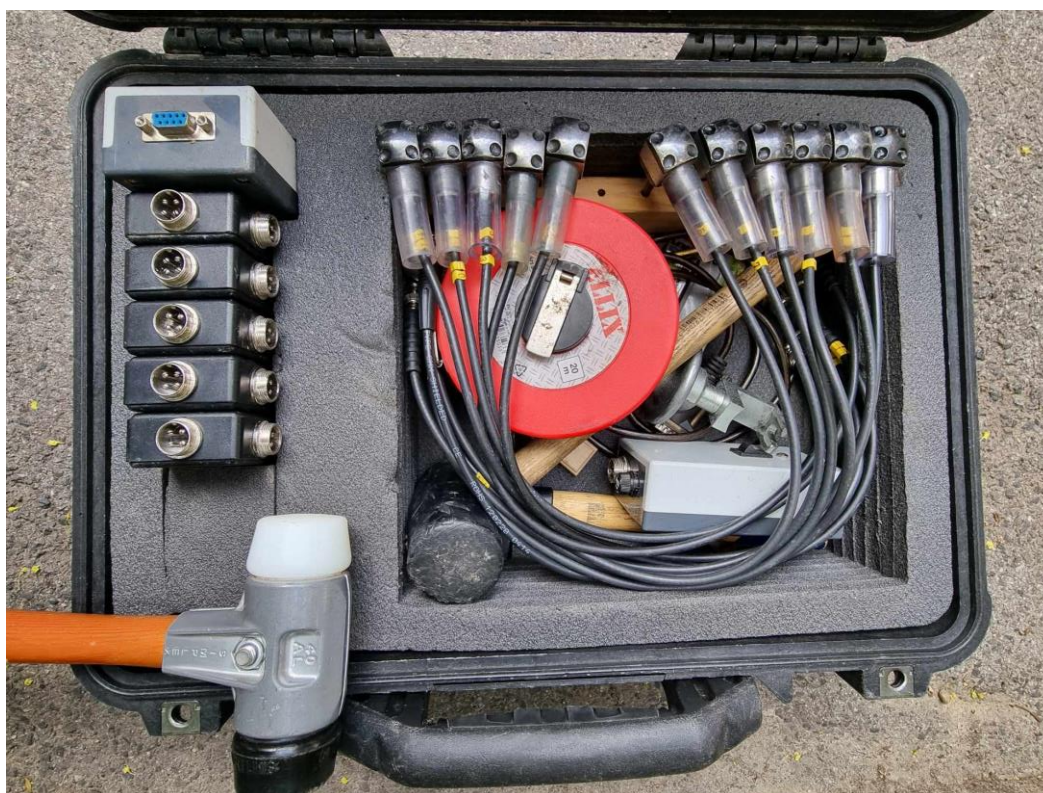
10. ábra: ArborSonic 3D akusztikus tomográf részei (Puskás, 2024)
