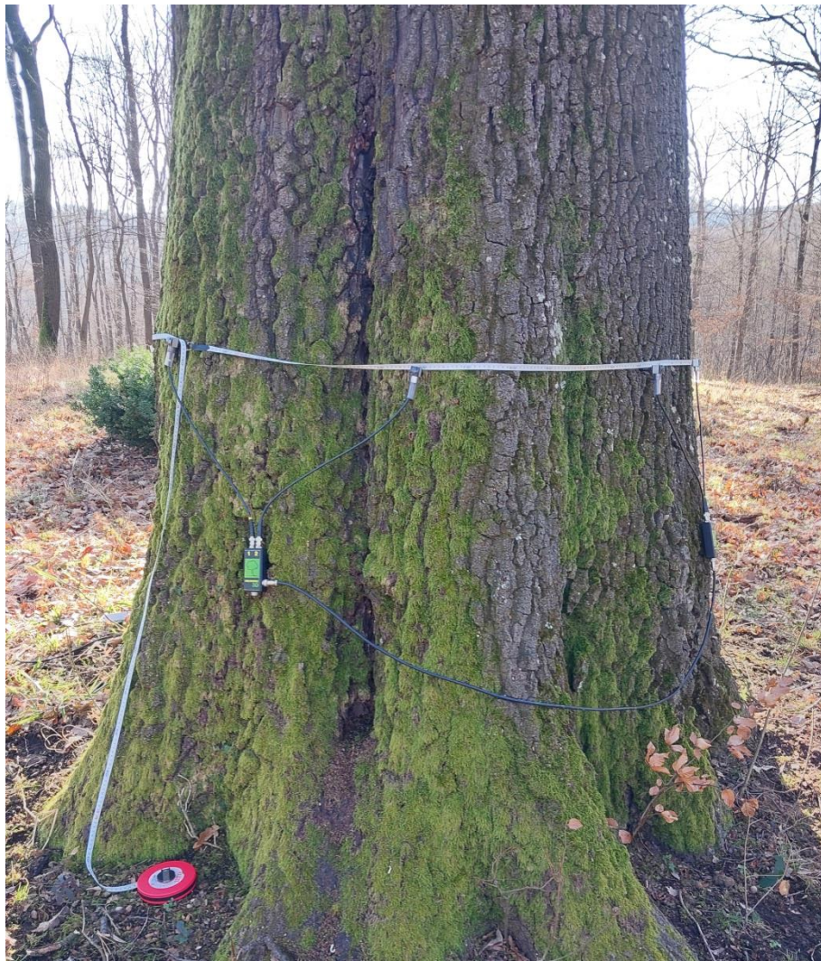
16. ábra: A fa törzsére felhelyezett érzékelők (saját felvétel, 2024)
