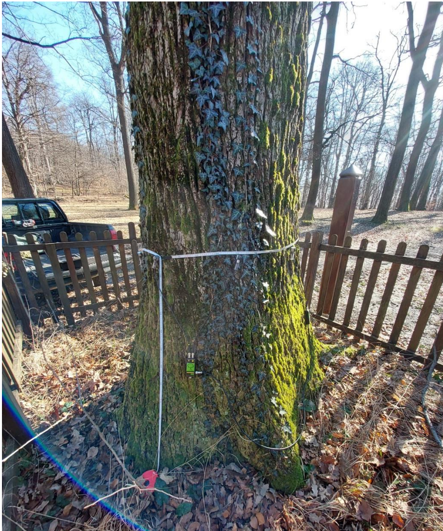
27. ábra: A fa törzsének műszeres keresztmetszeti vizsgálata (saját felvétel, 2024)
