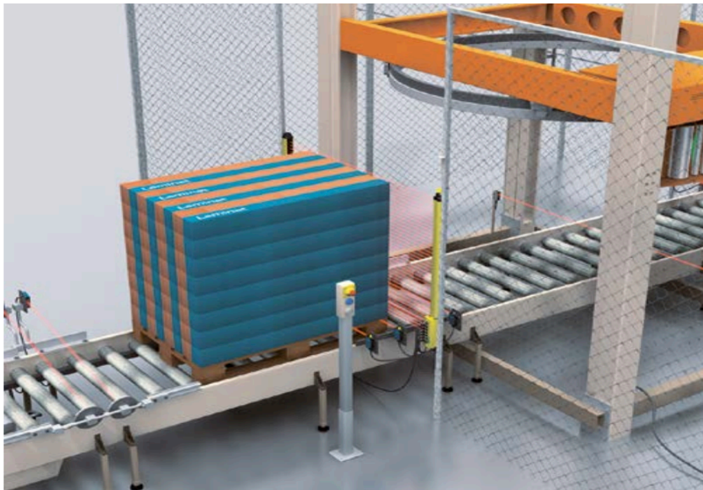
16. ábra Fénykapu optikai érzékelőkkel „mutingolva” [16, 3-38. oldal]
