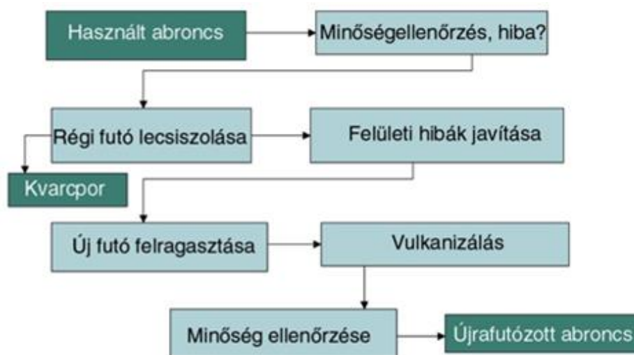
7. ábra Az újrafutózás technológiai vázlata Dr Sinka Gábor
