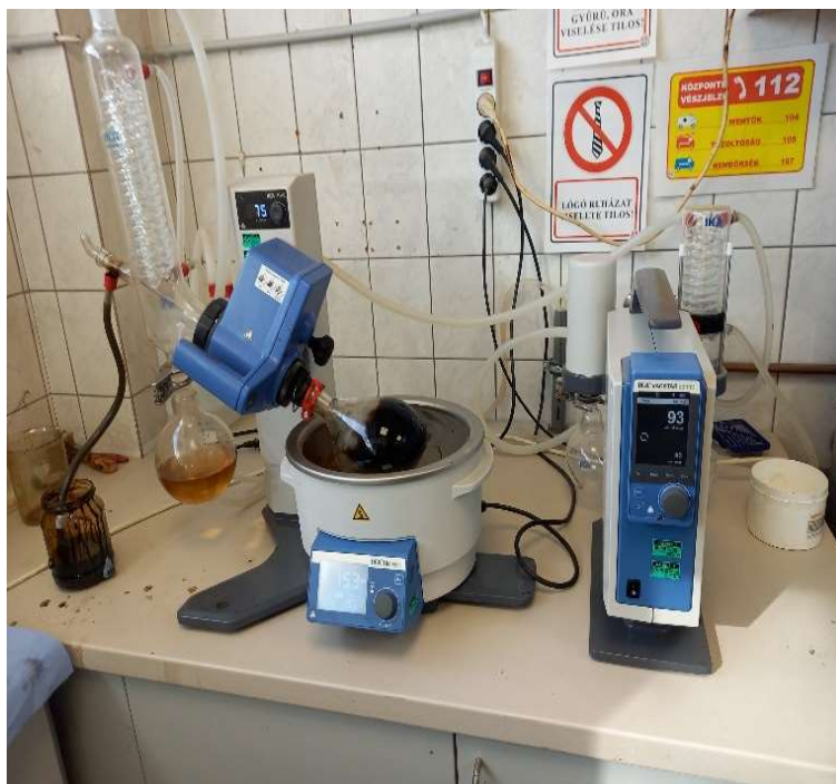
9.ábra Forgó bepárló készülék (saját fotó Eulab Kft. telephelyén)
