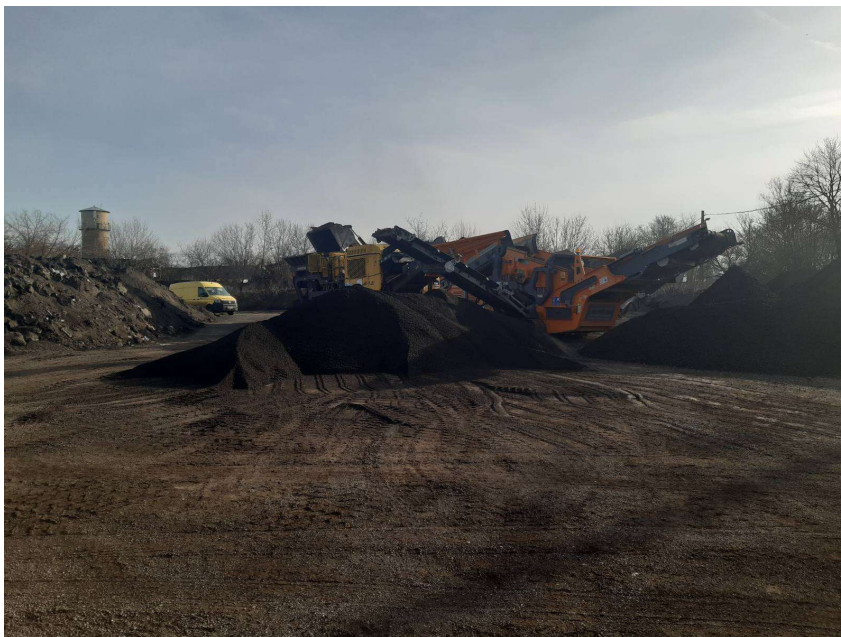
20. ábra A projekt során felhasznált martaszfalt törése és osztályozása (forrás: Swietelsky Magyarország Kft.)
