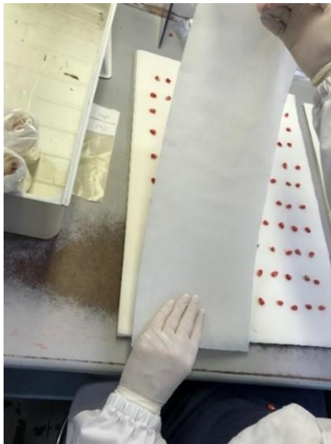
11. ábra Tekercsek elkészítése a csíravizsgálathoz (saját kép)
