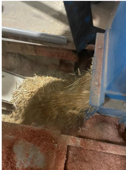
9. ábra Szármaradványtól eldugult selejtkihordó tisztítása (saját kép)
