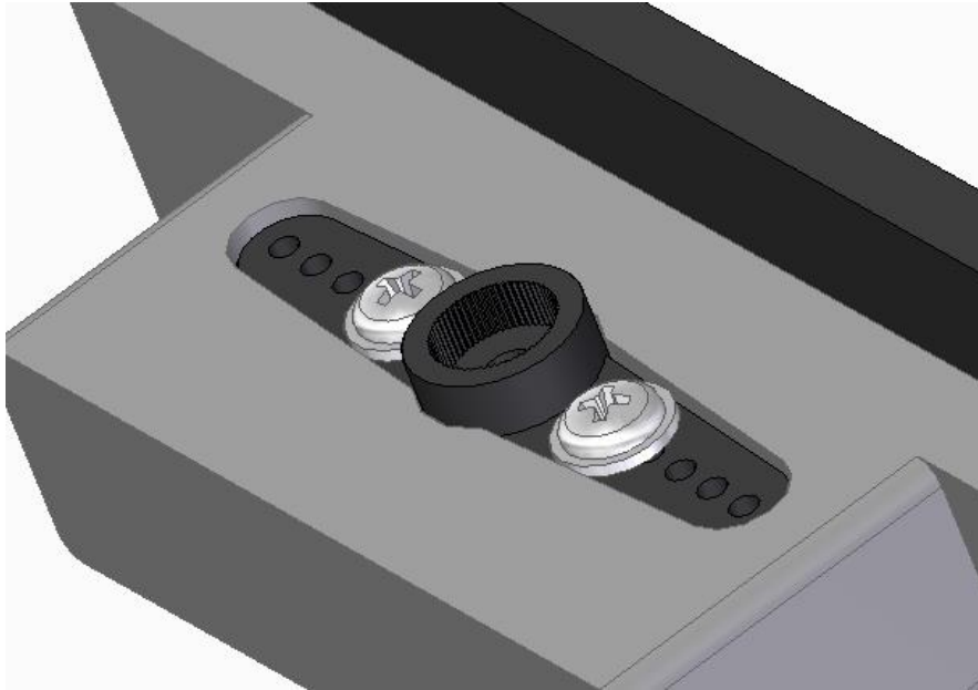
21. ábra: motor tengelyének rögzítése (saját ábra)
