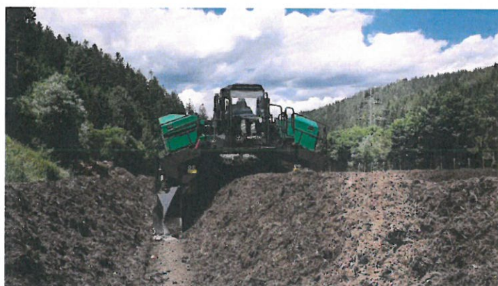
6. ábra: önjáró hidas komposztforgató (forrás: Komptech honlap;2024)
