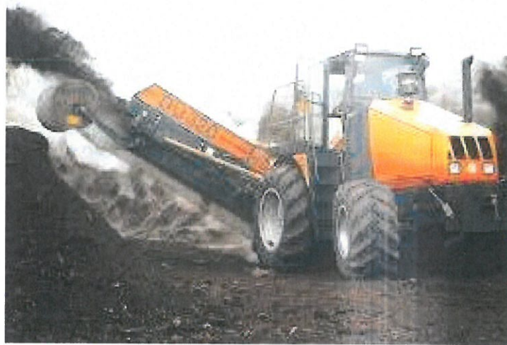
6. ábra: önjáró hidas komposztforgató (forrás: Komptech honlap;2024)
