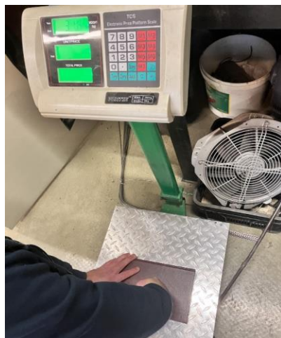
9.ábra. Egyszerű erőmérés a szorító erő meghatározására (helyszín: MATE-MI, Tanműhely)
