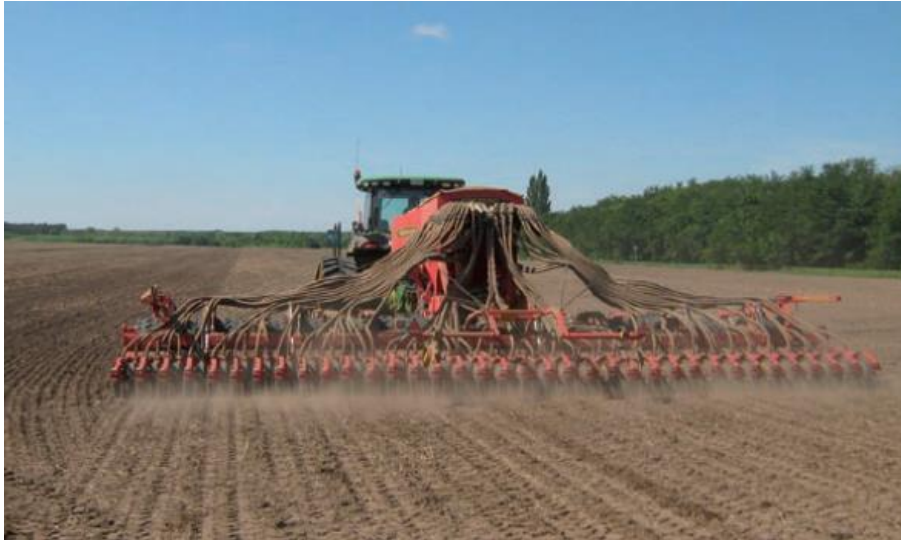
1. ábra: kombinált sorvetőgép (forrás: http 13.)
