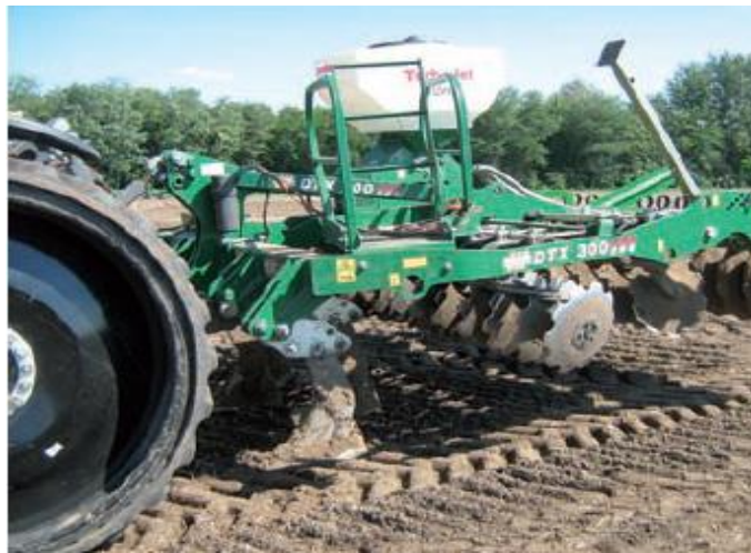
2. ábra: sávos szóróvető gép (forrás: http 13.)
