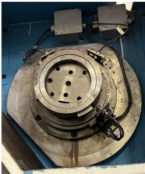
10. ábra: Tárcsa a főtengelyen és az érzékelők állítási lehetőségei Forrás: Saját készítésű fénykép
