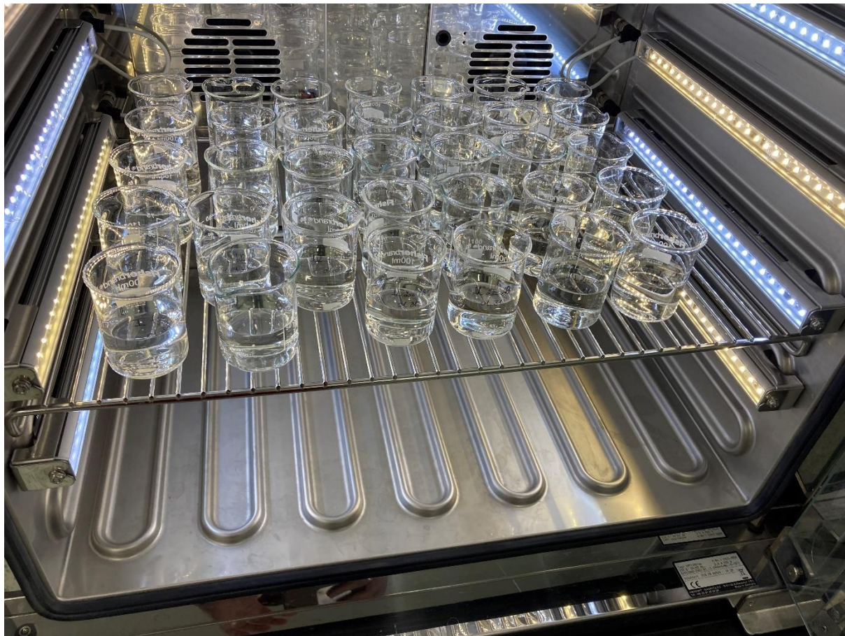
8. ábra: A mintákban és kontroll oldatokban tartott szervezetek inkubálása. Forrás: Tóth Gergő 2024.
