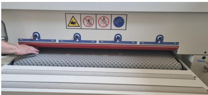
13. ábra: Első veszélyhelyzeti összekötősín (saját fotó)
