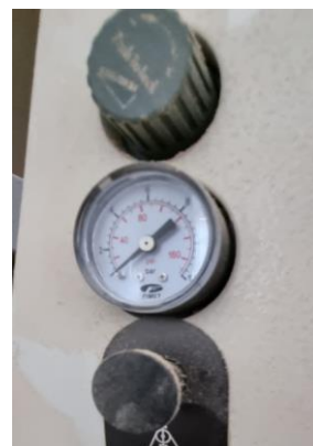
12. ábra: Üzemi nyomást mutató manométer (saját fotó)
