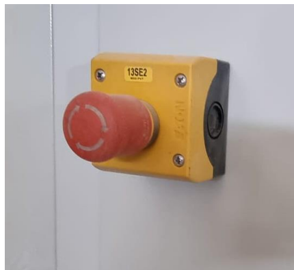
15. ábra: Vészleállító gomb a gép mindkét munkoldalán (saját fotó)
