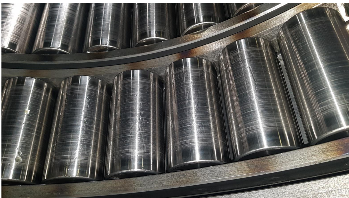
34.ábra: Csapágy sérült gördülő elemei. [saját fénykép]
