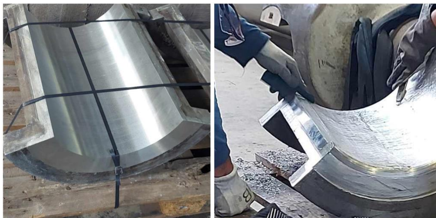
32.ábra: új (bal) és felújított (jobb) fehérfém csapágypersely. [saját fénykép]
