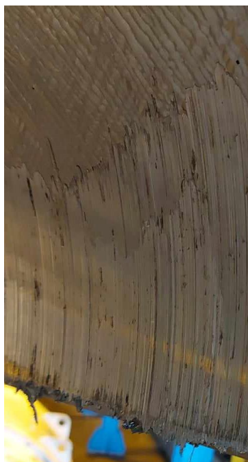
31.ábra: HH2 főmotor csapágypersely sérülés. [saját fénykép]
