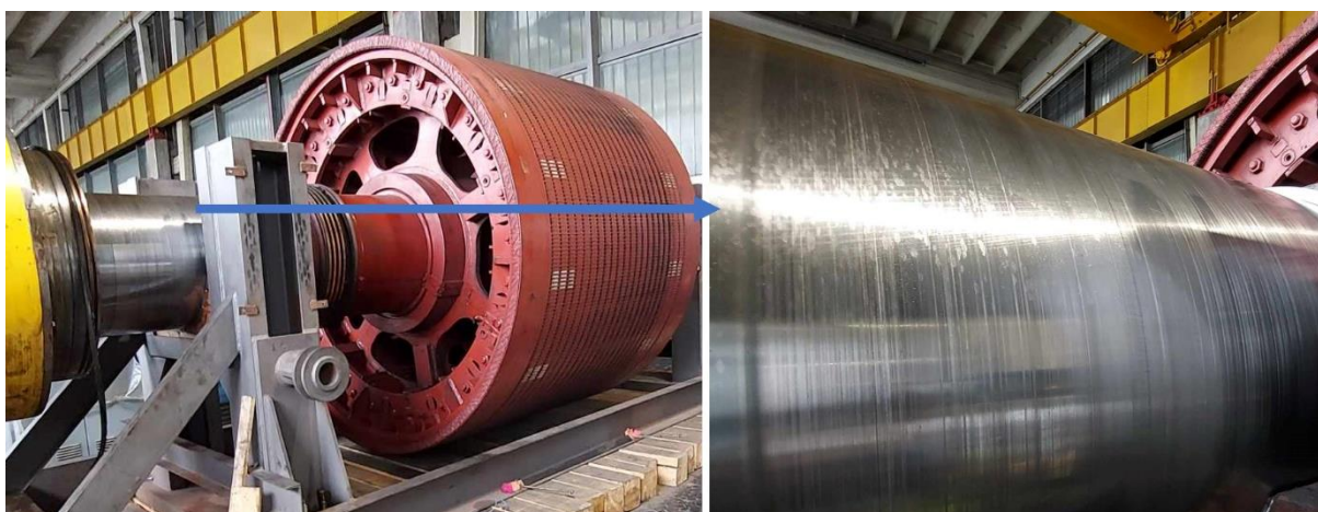
33.ábra: Meleghenger állvány főmotor forgórészének kopása. [saját fénykép]
