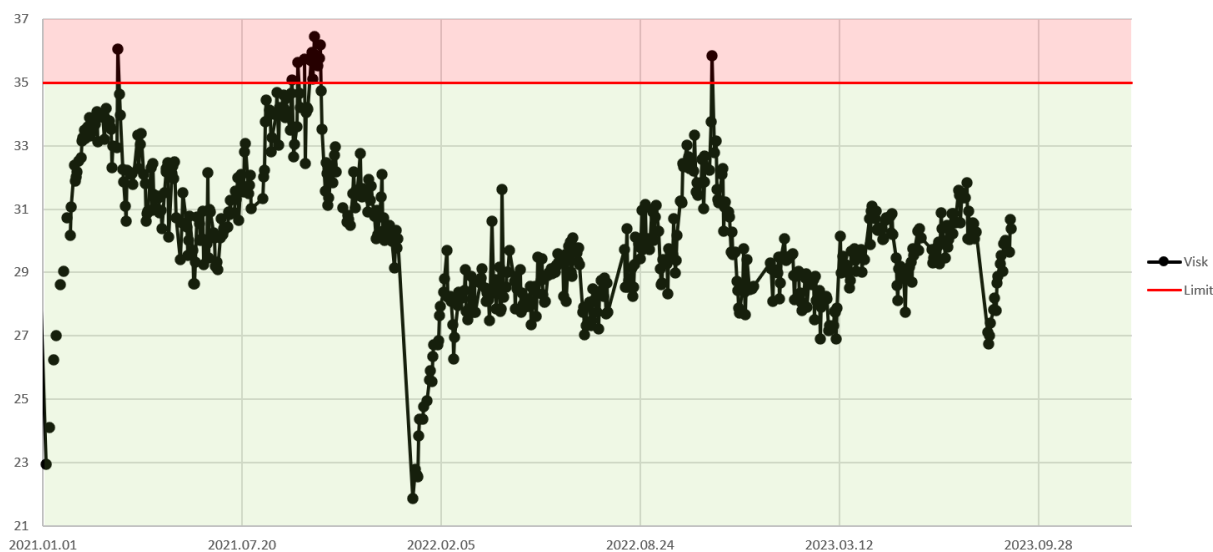
29.ábra: Üzemi emulzió minta viszkozitásának alakulása. [saját ábra]
