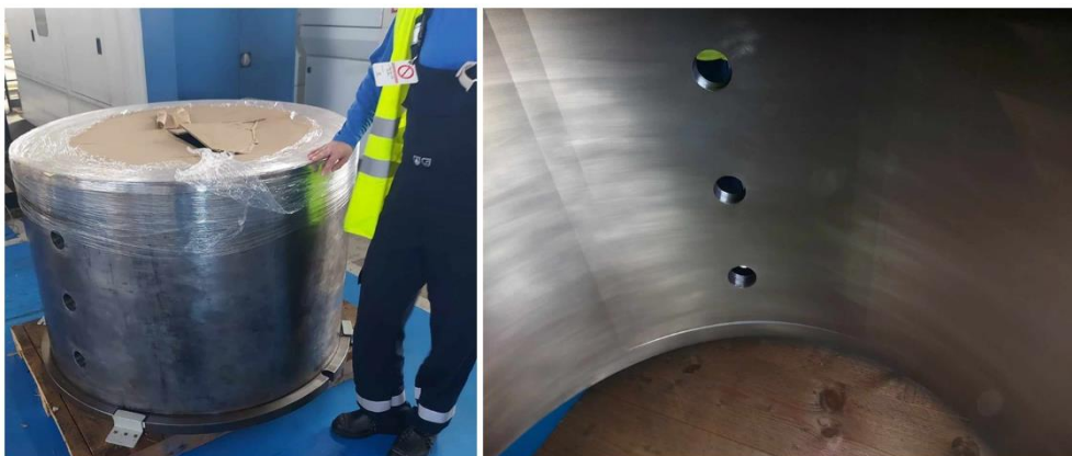
21.ábra: Meleghengerlési tám-henger csapágypersely felújítás után [saját fénykép]
