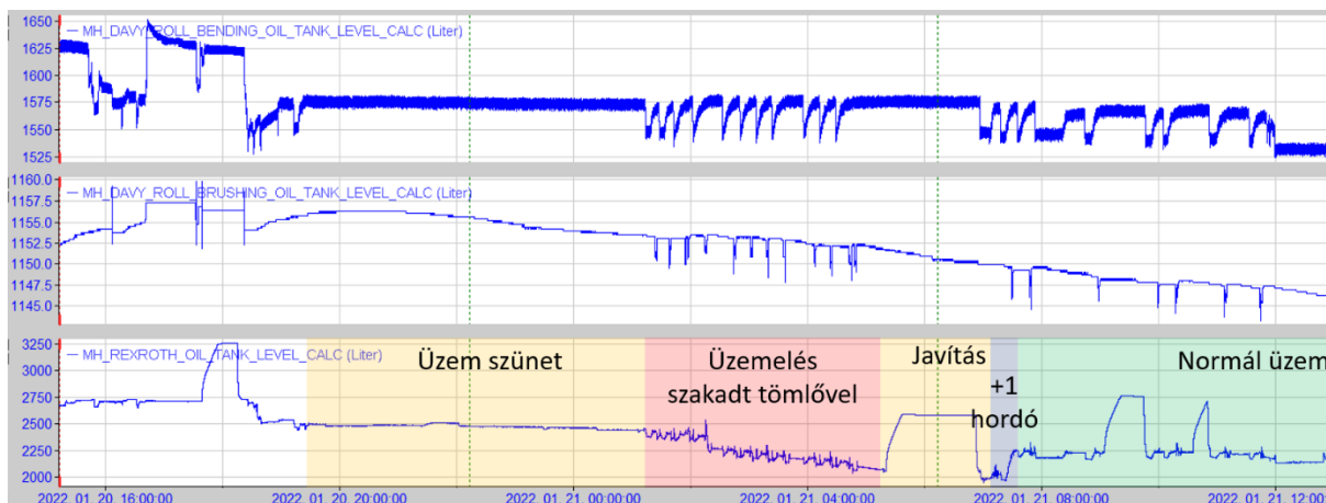
25.ábra: Tömlőszakadás okozta olaj folyás diagnosztikai jelei. [saját ábra]
