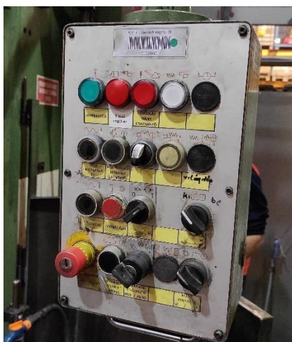
4. kép Felirat nélküli kezelő elemek
