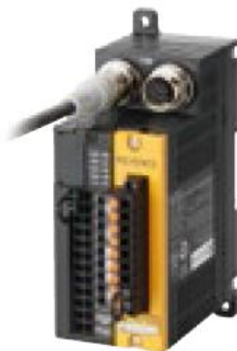
8. kép - Keyence GL-T11R biztonsági relé (forrás: www.keyence.com )
