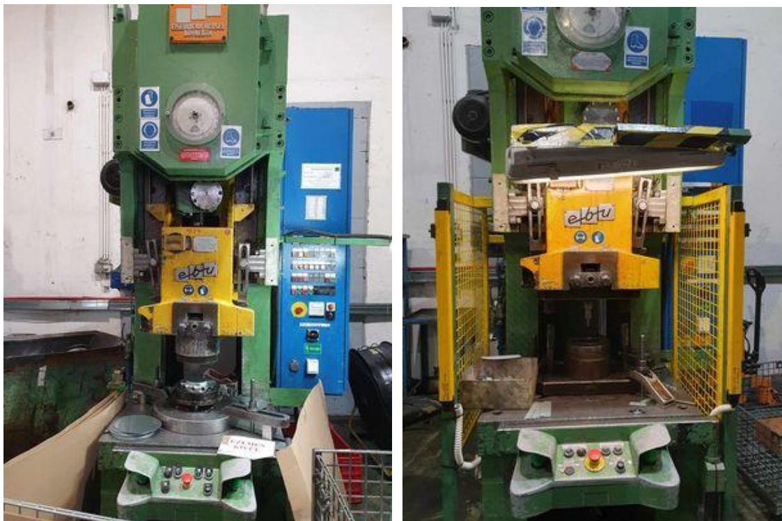
7. kép - Hensel 74288 prés fénykapu nélkül és fénykapuval (saját forrás)
