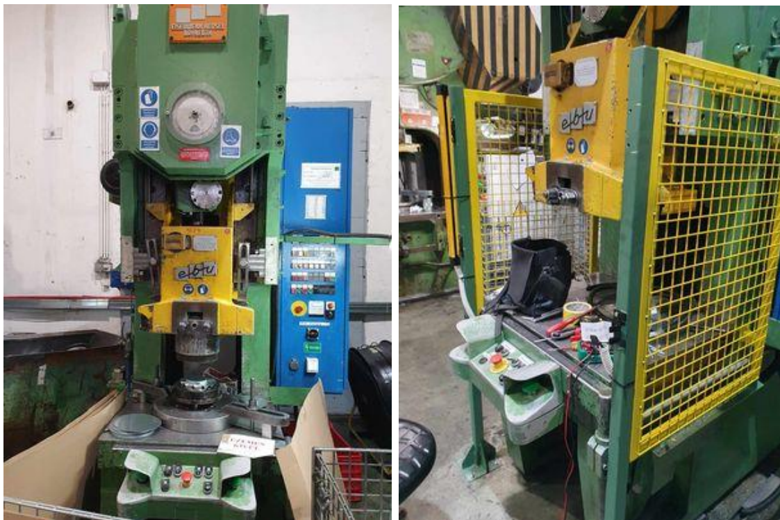
8. kép - Hensel 74288 prés védőburkolat nélkül és védőrácscsal (saját forrás)
