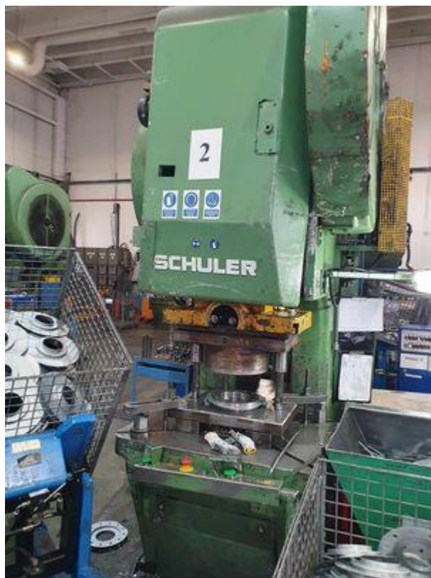
3. kép - Schuler 160 t ESP 5129 excenter prés (saját forrás)
